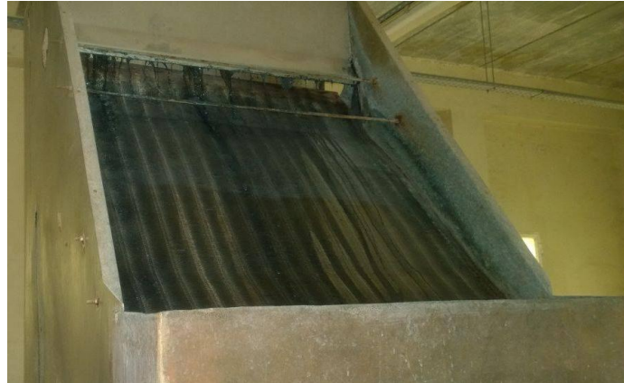
Figure 4 : photo représentant l'étape de dégrillage
