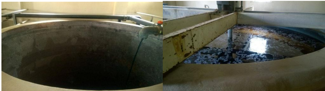
Figure 5 : photos représentant l'étape de décantation
