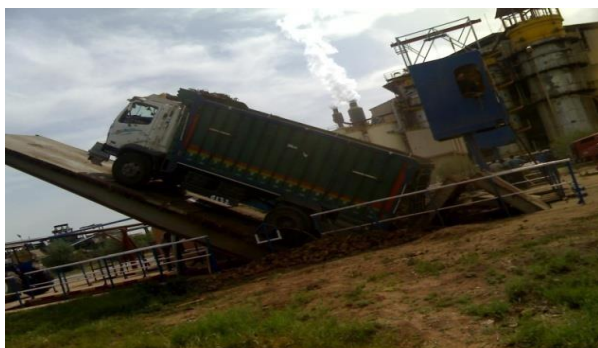
Figure 1: Déchargement des camions via une plate forme de basculage et bande mobile vers Stockage
