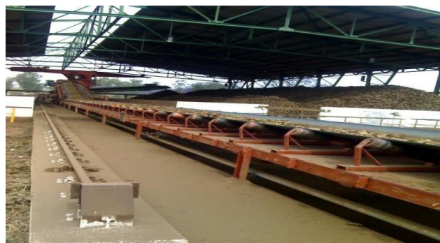
Figure 1: Déchargement des camions via une plate forme de basculage et bande mobile vers Stockage
