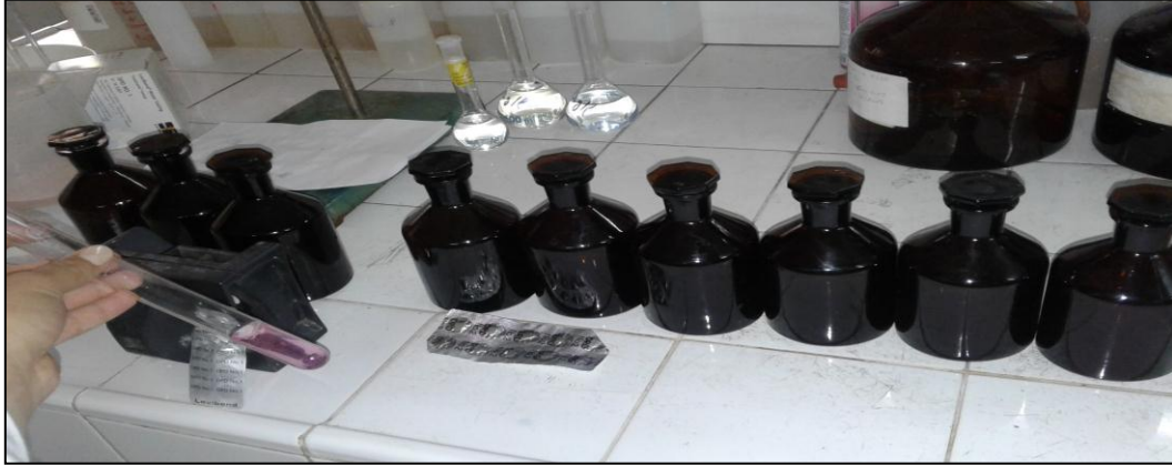
Figure 8 : Dosage du chlore résiduel par le comparateur
