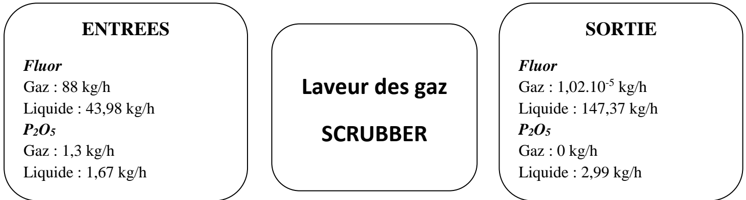
Figure 26 : Schéma du bilan Fluor et P2O5 par rapport la totalité de l'équipement
