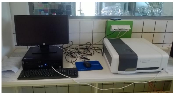
Figure 8 : spectromètre UV visible
