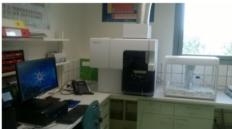
Figure 6 : système d'analyse ICP-AES
