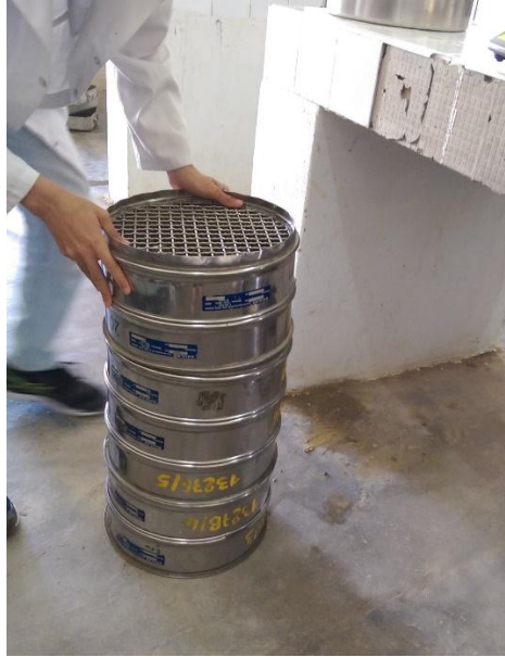
Figure 9. tamisage de l'échantillon
