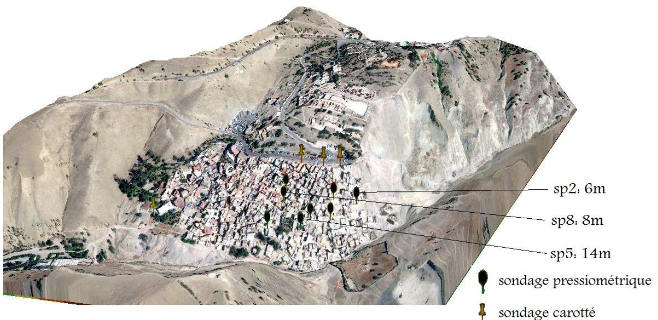
Figure 53 : Profondeur de la zone de rupture au niveau des sondages sp2, sp8 et sp5
