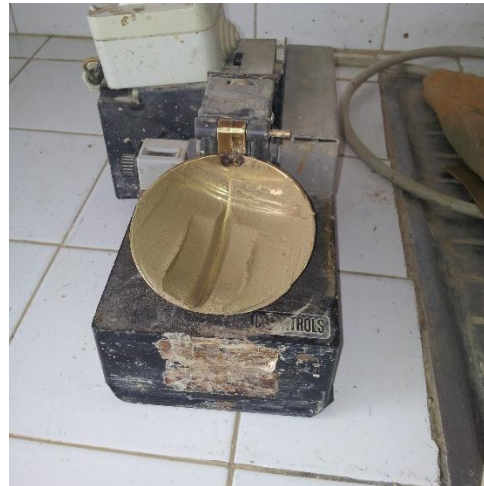
Figure 13: coupelle de Casagrande
