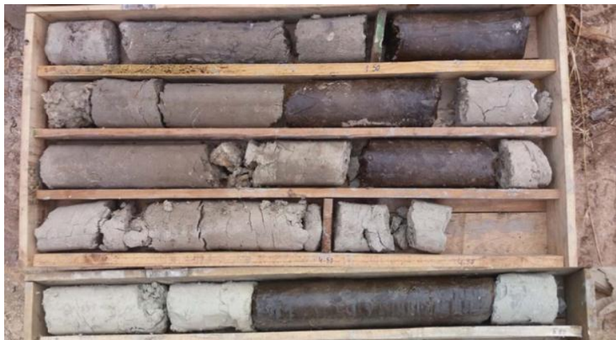
Figure 2. caisse de carottes destinées aux essais de laboratoire
