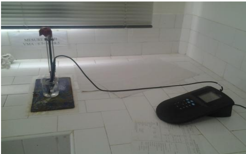
Figure 10 : pH-mètre contenant une sonde intégrée pour mesurer de la température.
