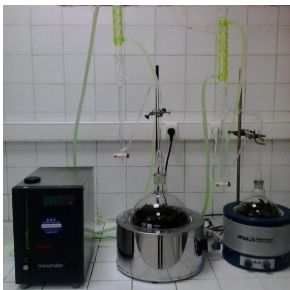
Figure 6 : Montage de l'appareil d'Hydrodistillation de type Clevenger
