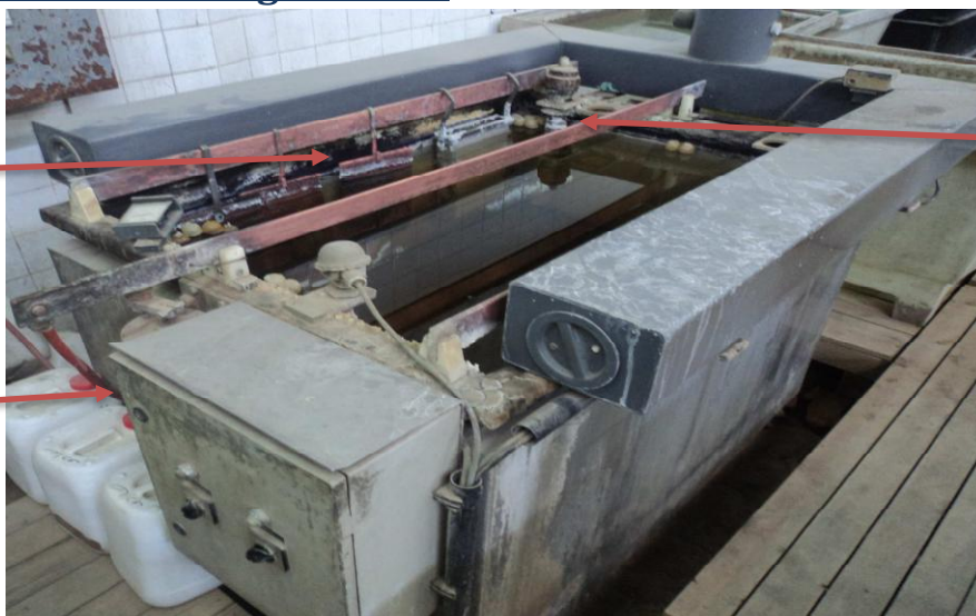
Figure 8 : Bain de cuivre alcalin
