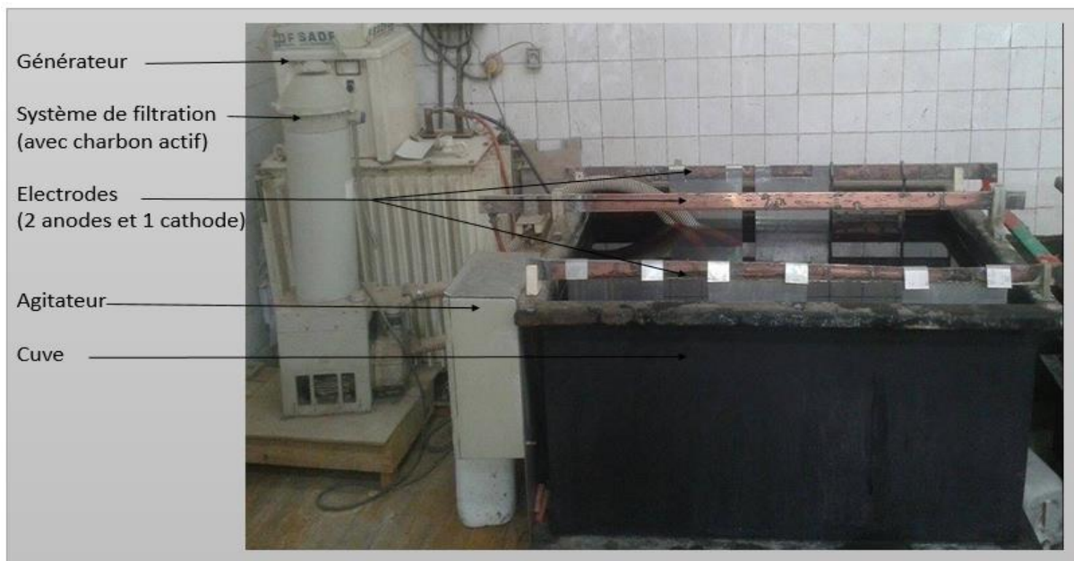
Figure 13 : Schéma général du bain électrolytique
