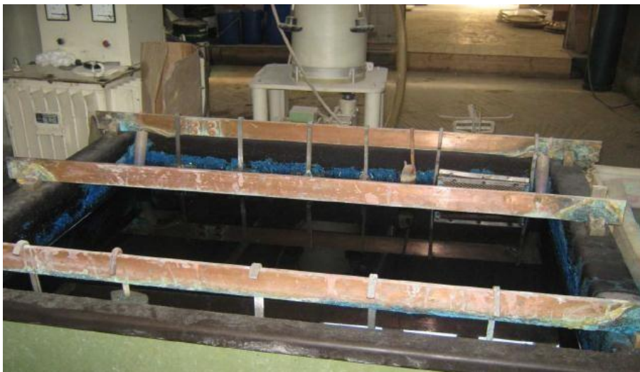
Figure 9 : bain de cuivre acide
