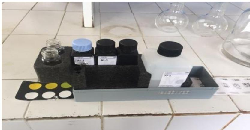
**Figure 14: kit de mesure d'aluminium**
