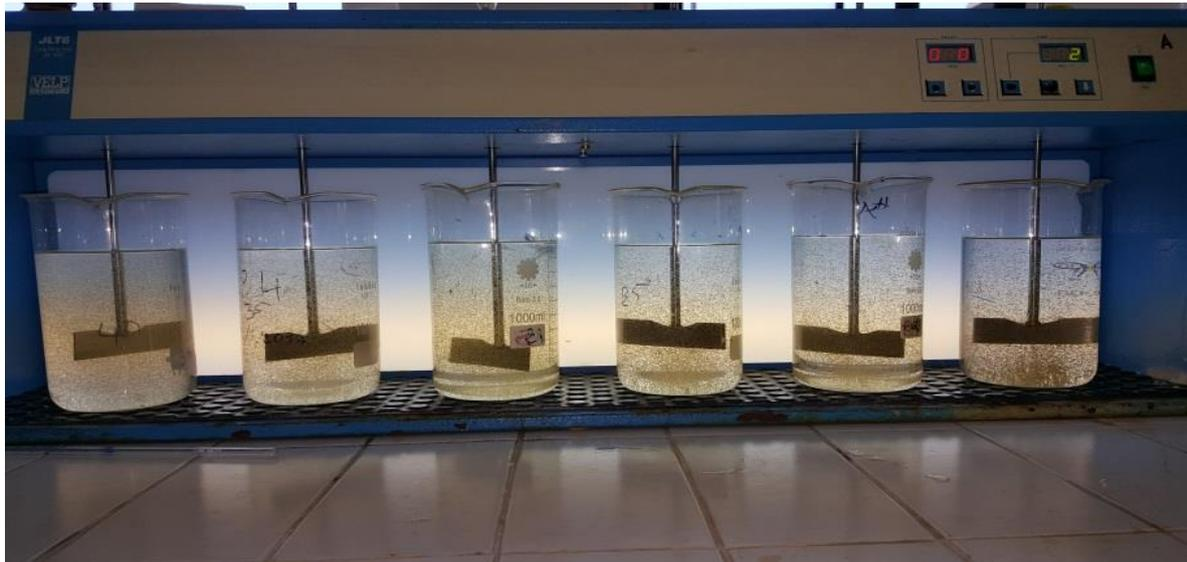
**Figure 13: Appareil de jar test**
