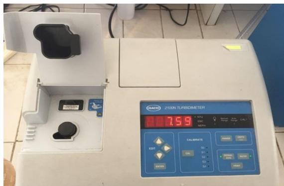
Figure 9: Turbidimètre
