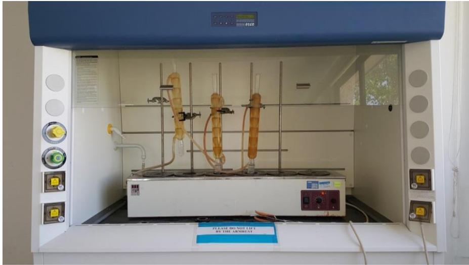
Figure 11: Appareil d'oxydabilité
