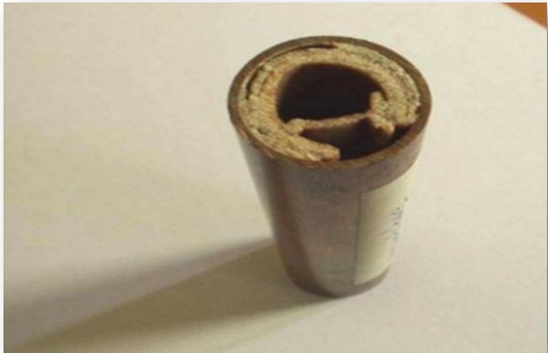
Figure 12 : Dépôt de tartre dans une canalisation de cuivre
