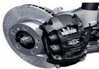
Figure 4 : liaison de Disque de Frein par l'étrier
