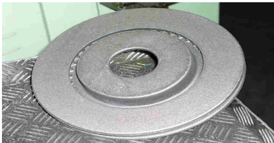
Figure 7 : Disque de frein brut avant le Tournage
