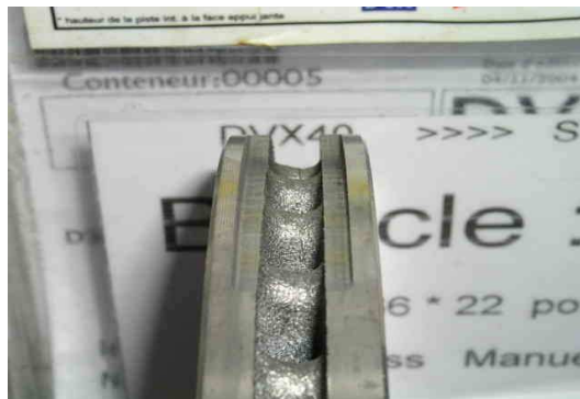
Figure 10 : Disque de frein ventilé après l'équilibrage
