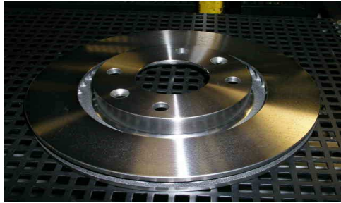
Figure 9 : Disque de frein ventilé après l'Ebavurage
