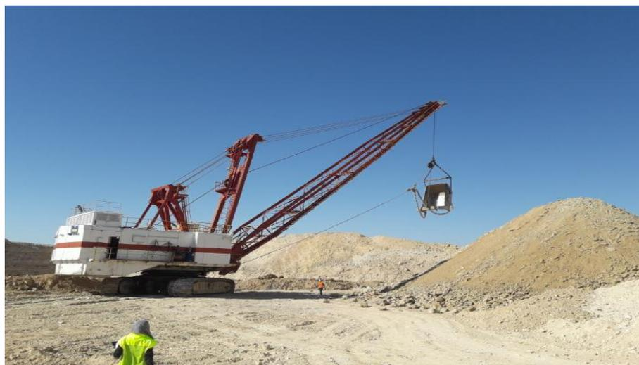
**Photo 7: Décapage par Casement (Engin 195M).**
