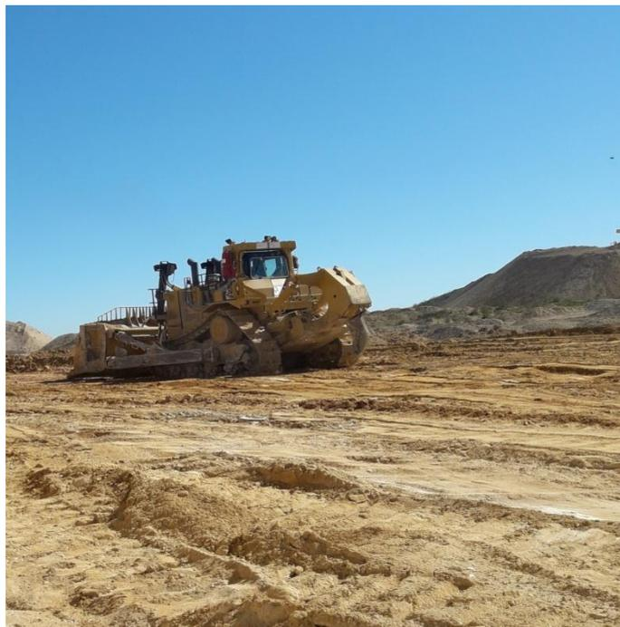
**Photo 6: Décapage par poussage vers la tranchée (n-1) déjà exploitée.**
