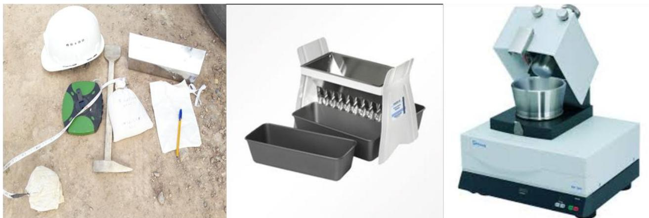
**Photo 1: Matériel d'échantillonnage, Appareil de quartage en inox et Broyeur mécanique à mortier.**
