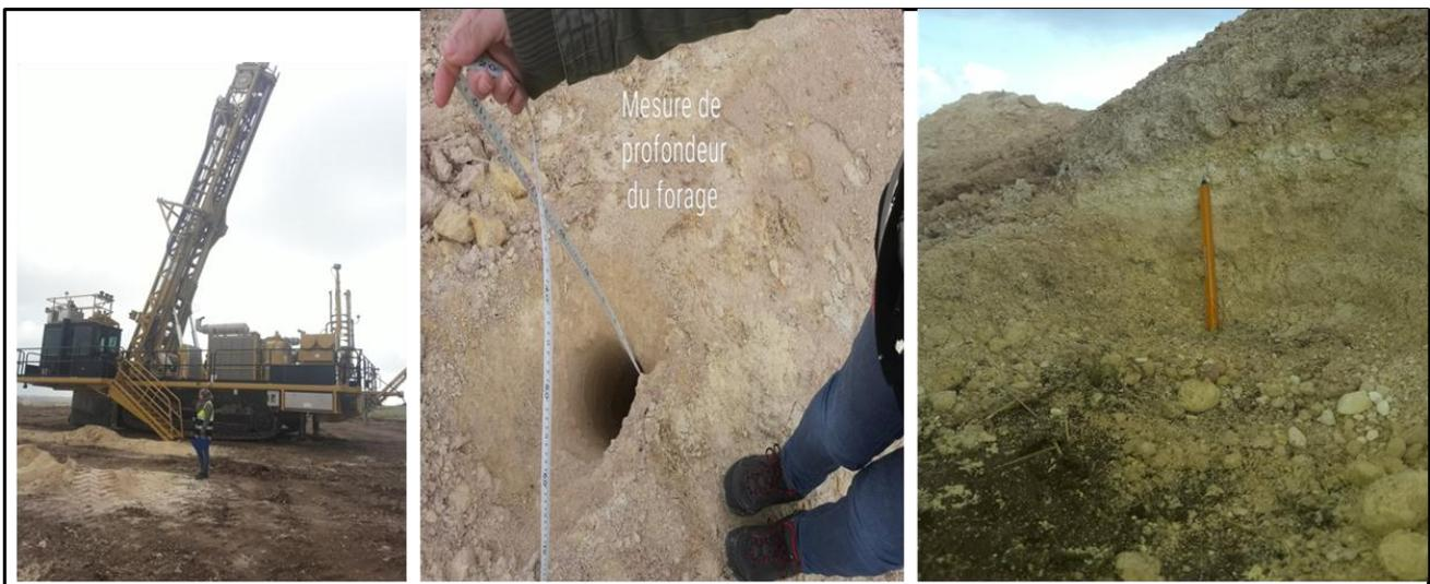
Photo 5: Sondeuse à foration inclinée 30 à 40°, série phosphatées renversée (Cuttings)
