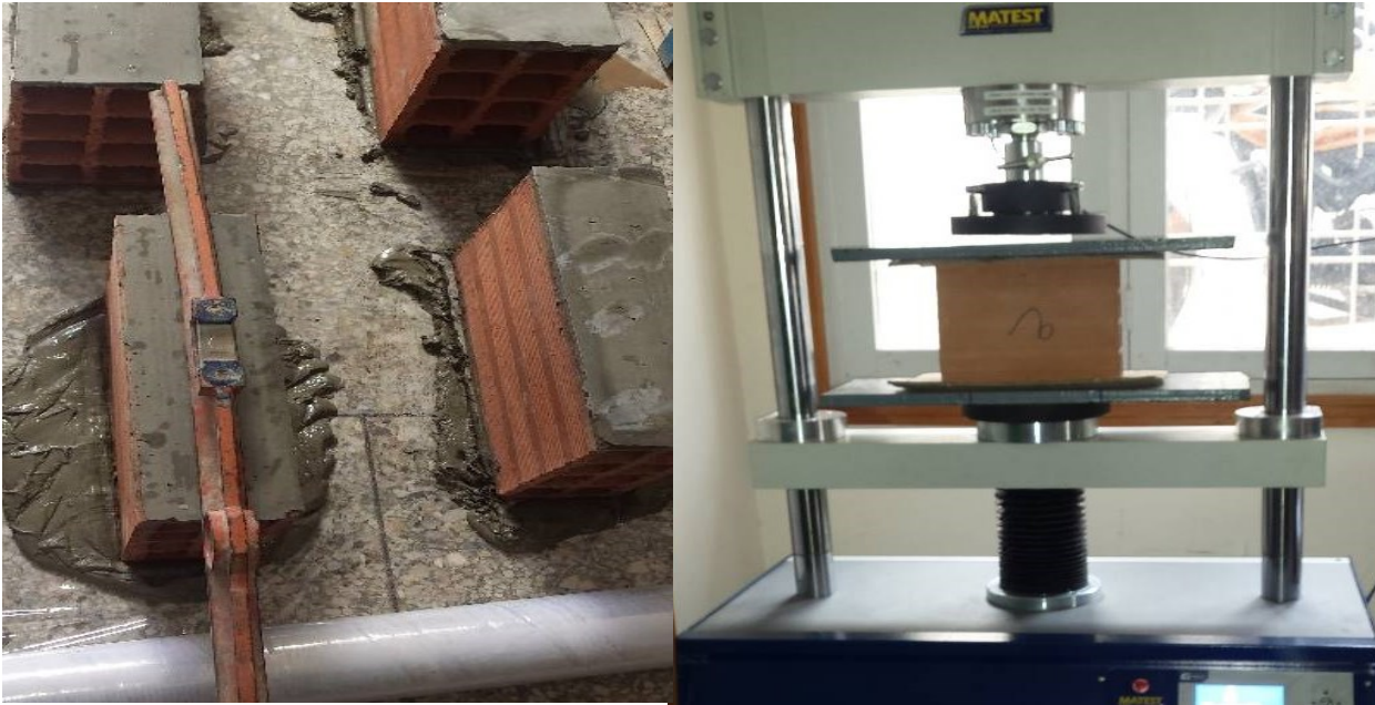
Figure 26 : Rectification et compression des briques
