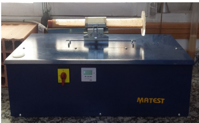
Figure 3 : L'équipement de la détermination de l'équivalent de sable
