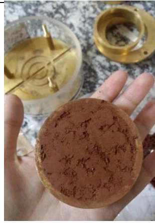
Figure19 : Remplissage de l'éprouvette par le matériau
