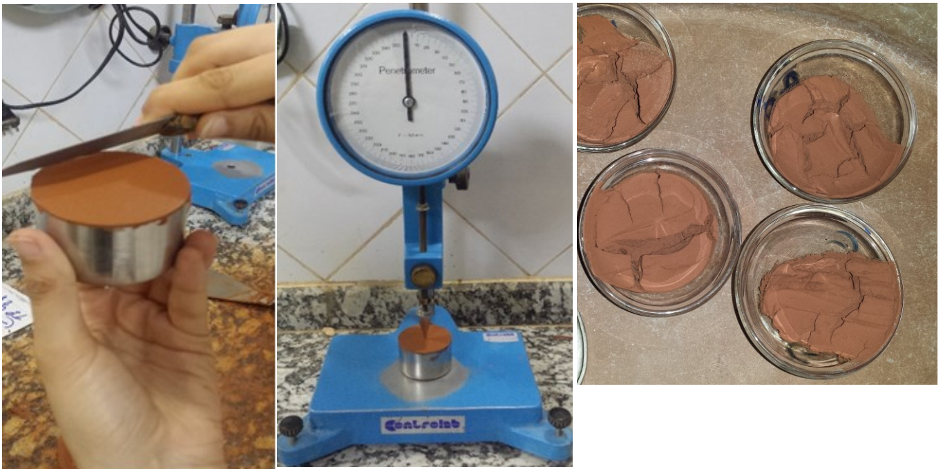
Figures 5 : Le Rasage du matériau – Pénétromètre -Dessiccation du matériau.
