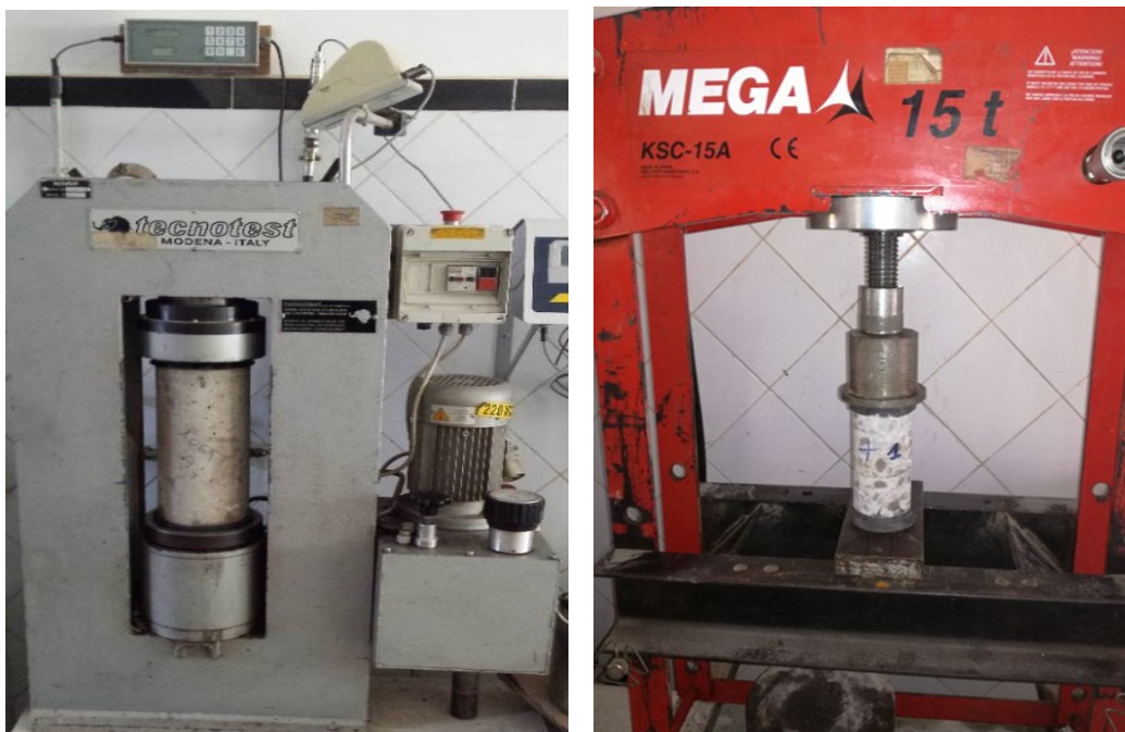
Figure 25 : Compression des éprouvettes de Béton durci
