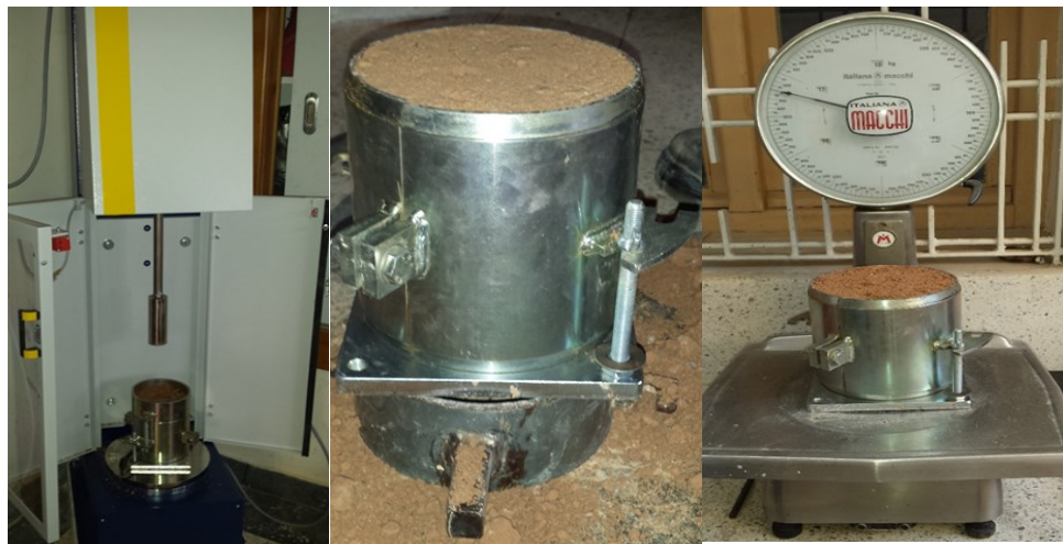
Figure 16: Les étapes de l'essai Proctor
