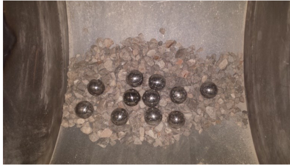
Figure 10 : Les boulets métalliques et l'échantillon.
