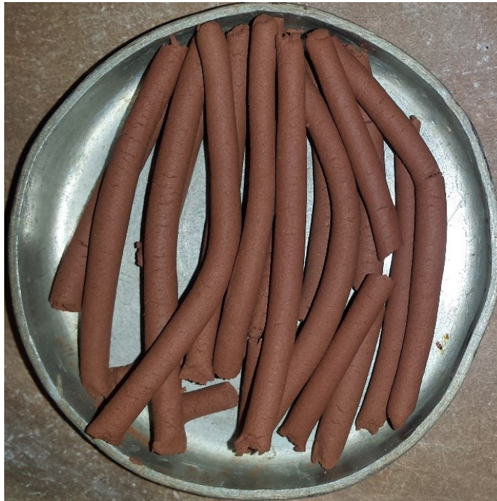
Figure 6 : Les rouleaux fissurés.
