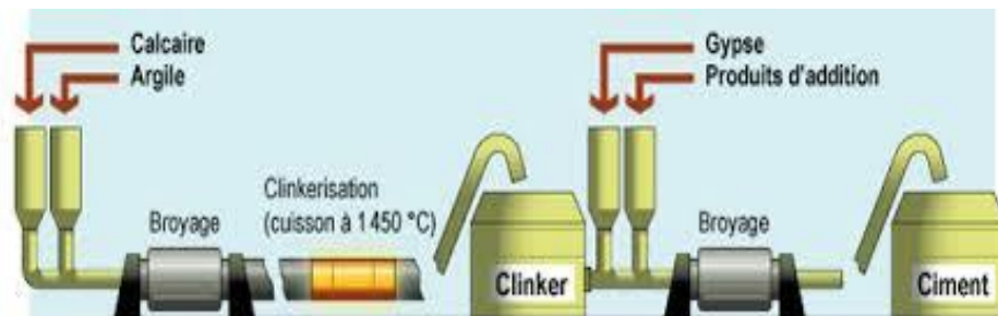
Figure 2 : processus de production du ciment
