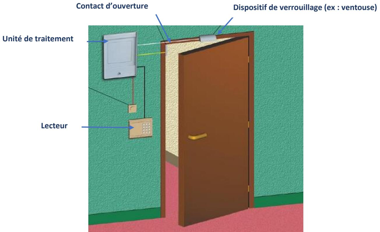
Figure 50: L'exemple de la configuration d'un système de contrôle d'accès
