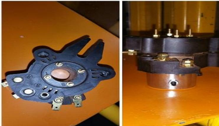
*Figure 26: L'alimentation par le collecteur rotatif*
