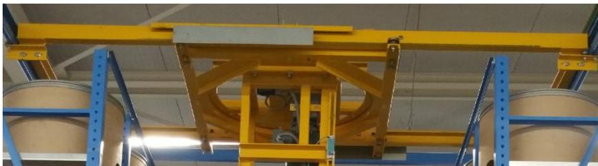
Figure 17: le système de translation et rotation du gerbeur
