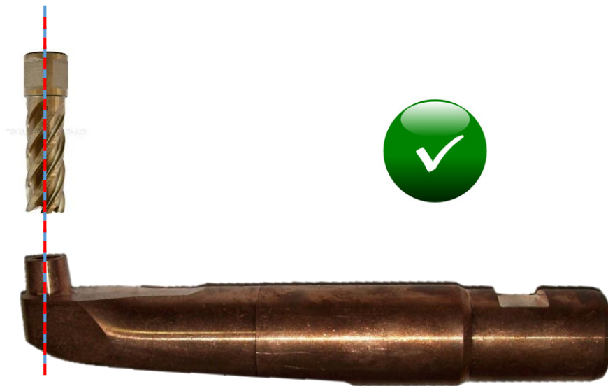
Figure 29: Bon alignement broche tête-allonge
