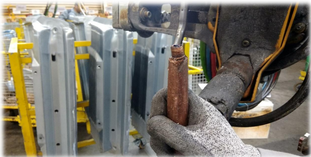
Figure 27: Déterioration au niveau de la tête d'allonge
