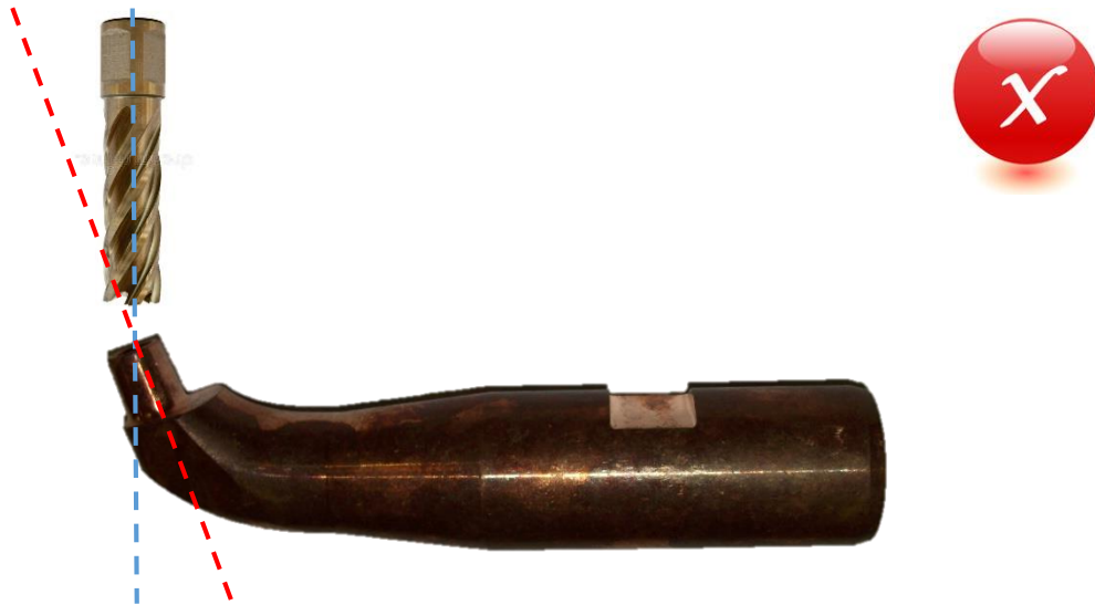
Figure 30: Mauvais alignement broche tête-allonge
