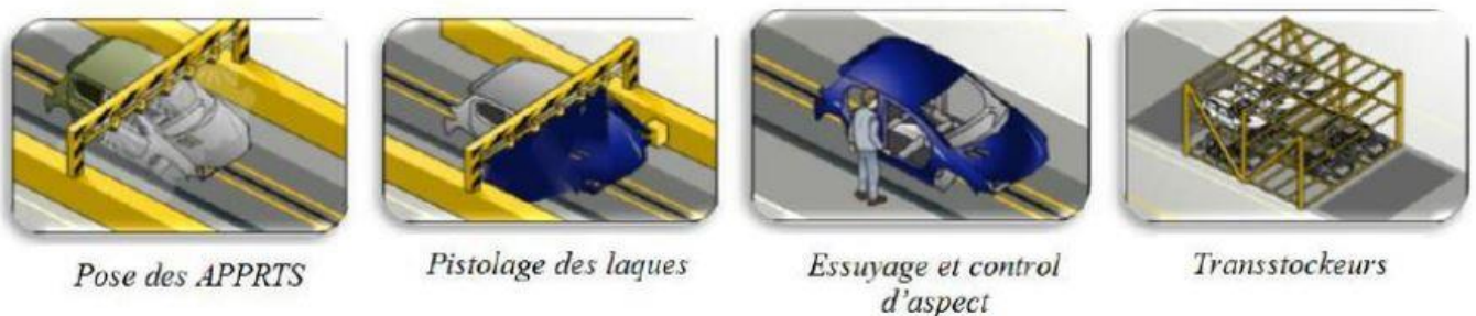
Figure 11: Etape 1 - Traitement de surfaces au Département Peinture
