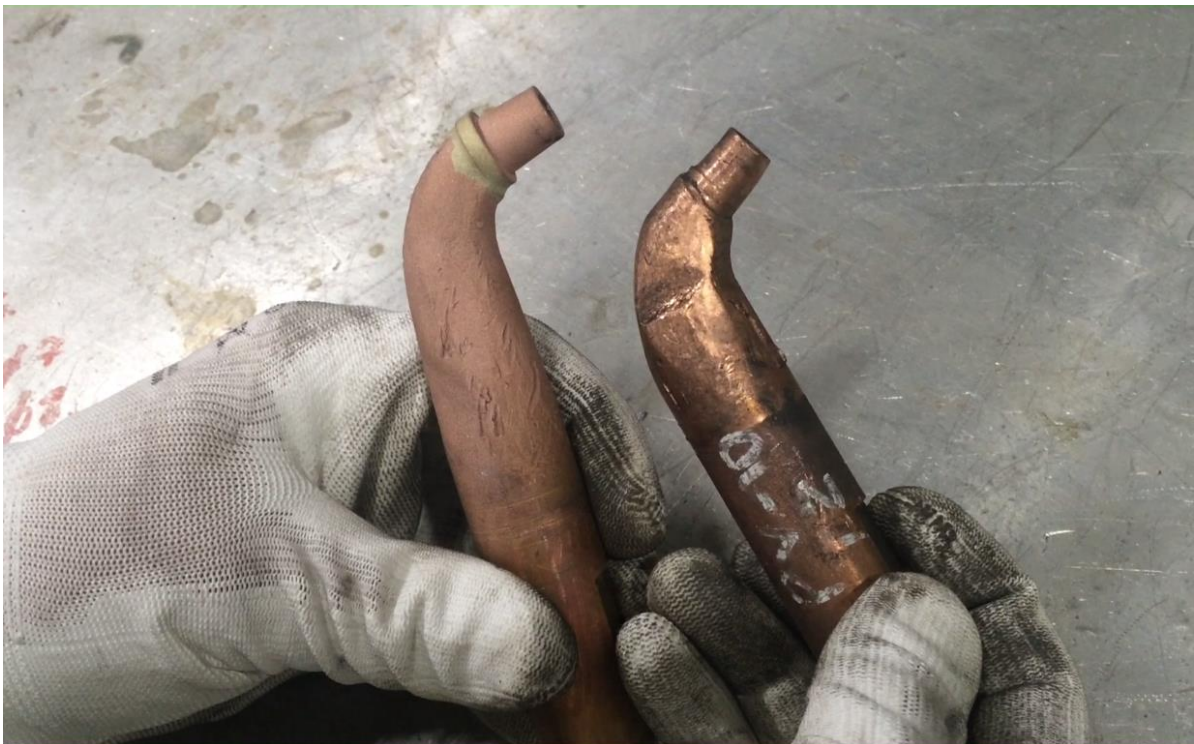
Figure 51: Comparaison Allonge dégradée et recyclée
