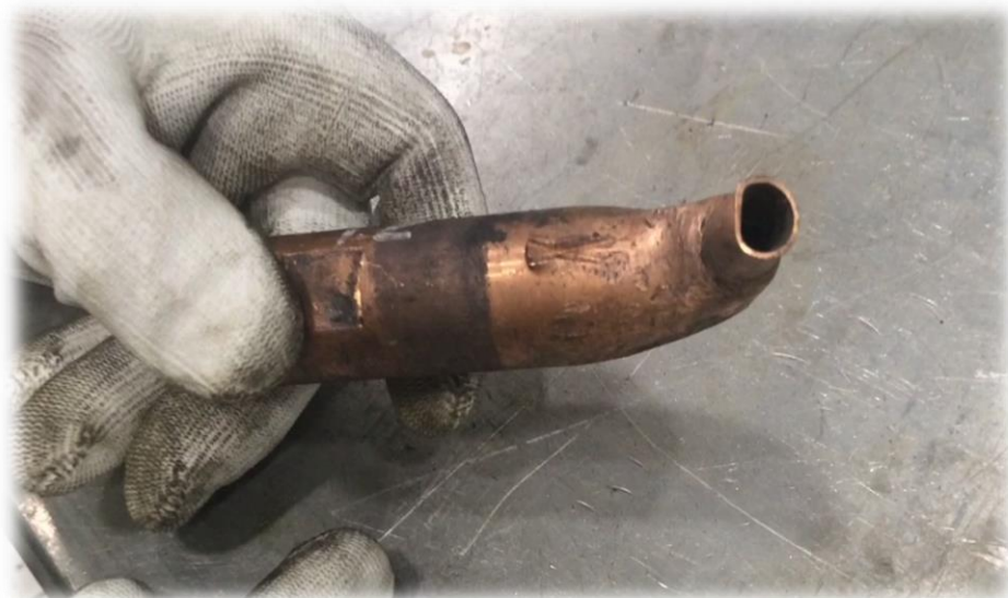
Figure 35: Allonge avant fraisage
