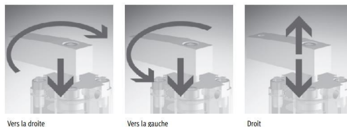
Figure 8: Les sens d'oscillations d'un vérin de bridage.
