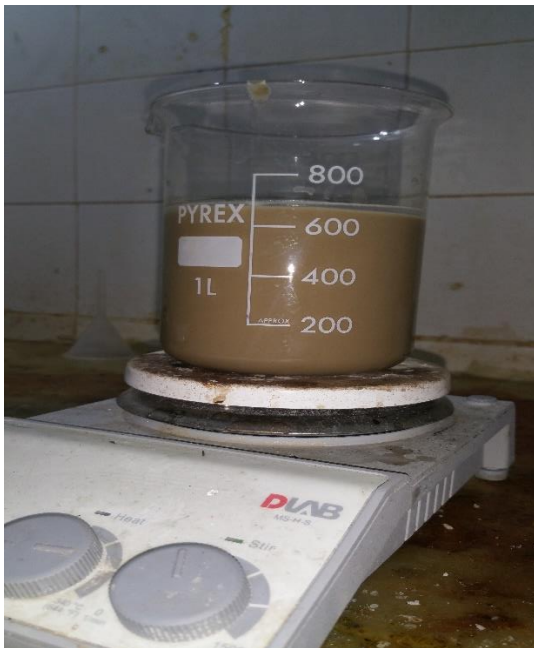
Figure 4 : La bouillie en agitation
