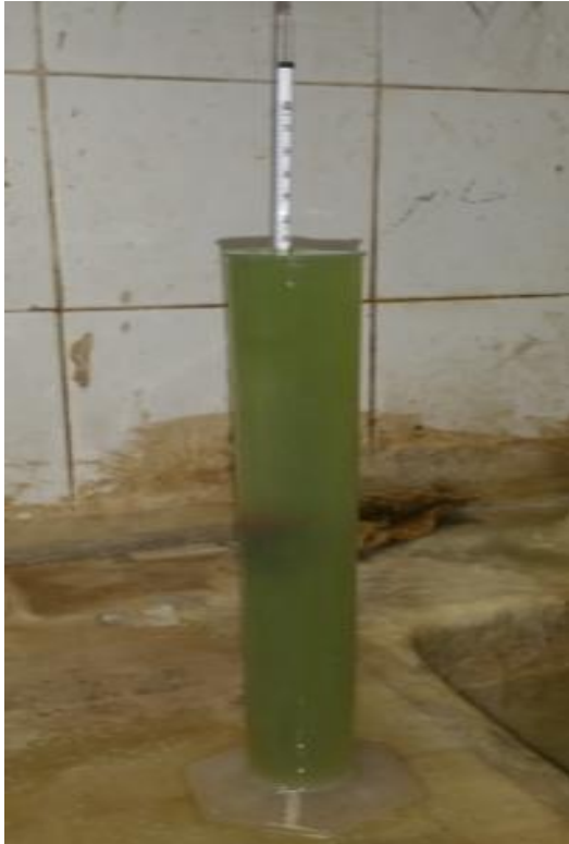
Figure 8 : Mesure de la densité avec un densimètre
