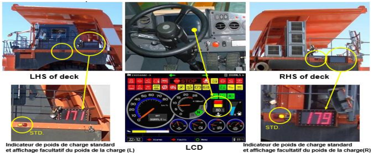
Figure 86: indicateurs du poids sur le camion.
