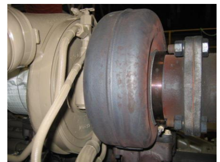
Figure 42: Deux nouveaux Holset HX83 turbos à haute pression
