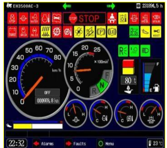
Figure 80: Indicateur central spectacles alarmes ATTENTION et STOP
