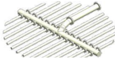
Figure 38 : Système de distribution à barillets perforées
