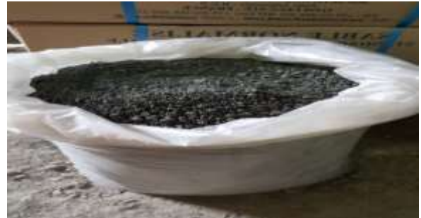
Figure 32:clinker après concassage
