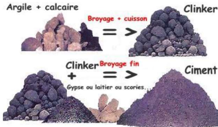
Figure 3: Chaîne de transformation du calcaire et d'argile en ciment
