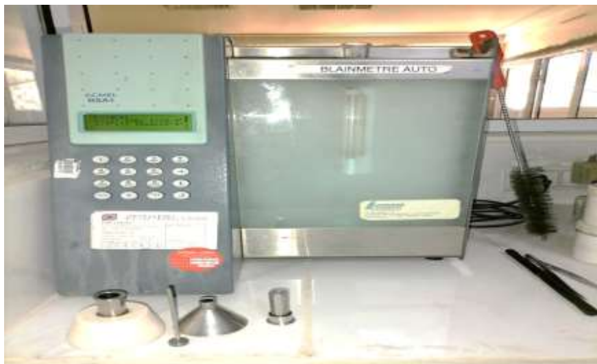
Figure 14: Perméabilimètre de Blaine
