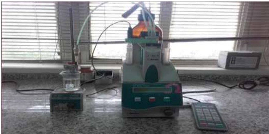
Figure 11: Titreur des ions en chlorures
