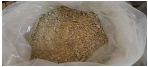
Figure 29:calcaire après concassage
