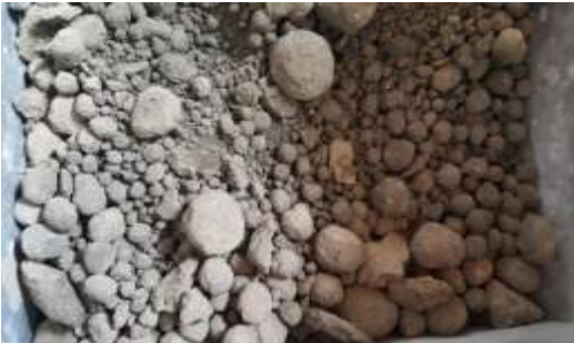
Figure 31:clinker avant concassage
