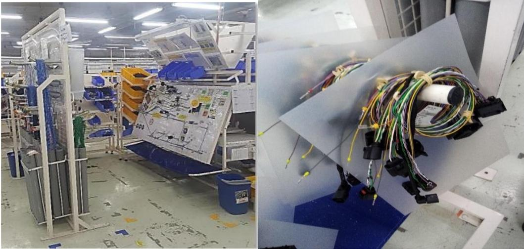
Figure 27: Poste de façonnage PIM2
