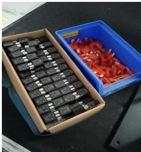
Figure 54: Les fusibles du poste test électrique
