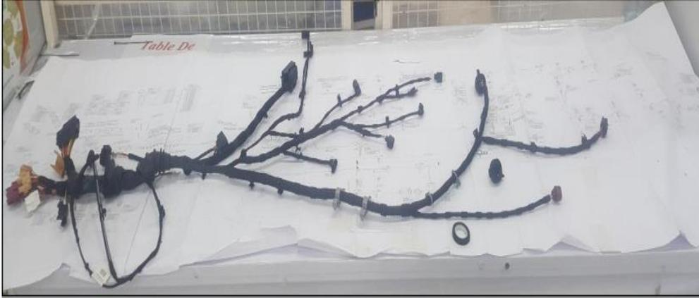
Figure 4: exemple d'un faisceau électrique
