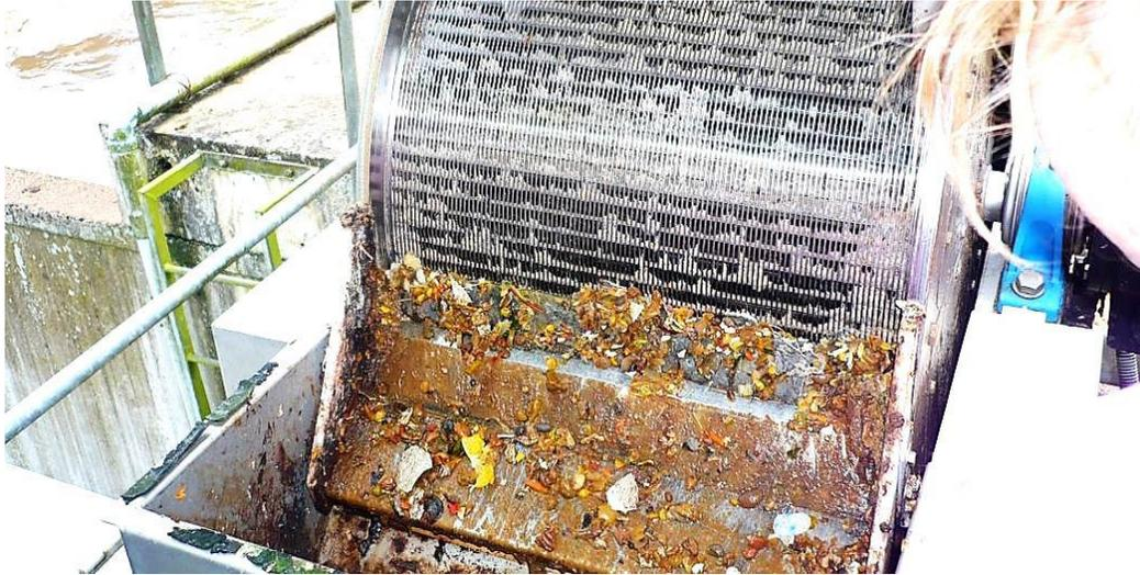
**Figure 2: Méthode de dégrillage de l'eau**
