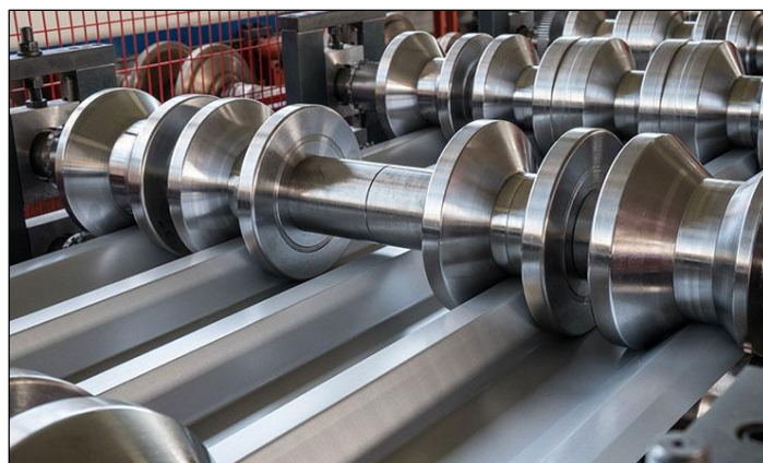
Figure 10: Production du TOLADALA à l'aide du ROLL FORMING.
