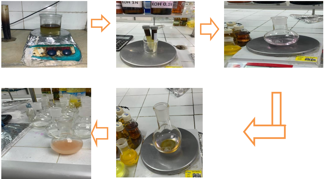
Figure 9 : résultats d'analyse de l'acidité de la pâte
