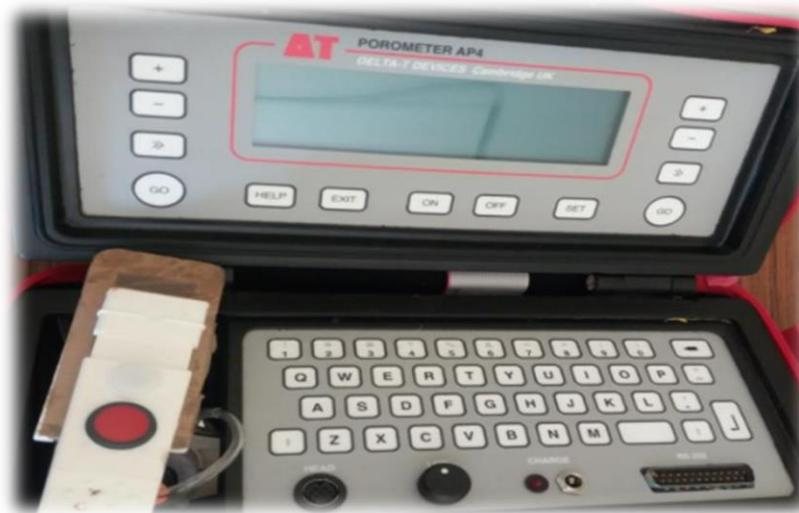
*Figure 8: Appareil de mesure de la conductance des stomates.*
