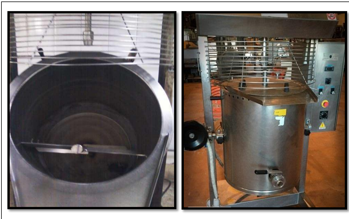
Figure 9 : Cuiseurs à chaudières munis d'un système d'agitation
