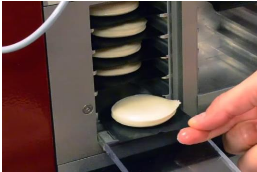
Figure 30 : Mise à l'étuve
