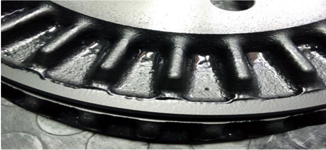
Figure 17:Défauts de séchage (tache d'eau)
