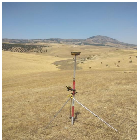
Figure 14: Levés de coordonnées sur le terrain par le GPS pour le rétablissement de bornes
