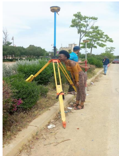
Figure 5: GPS sur trépieds (opération de bornage sur terrain)
