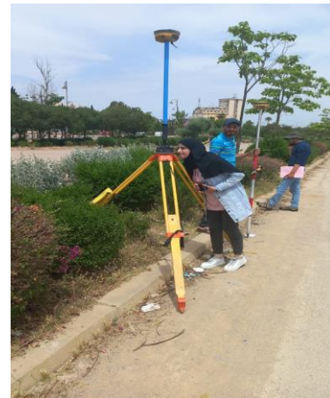
Figure 7: GPS sur trépieds (opération de bornage sur terrain)
