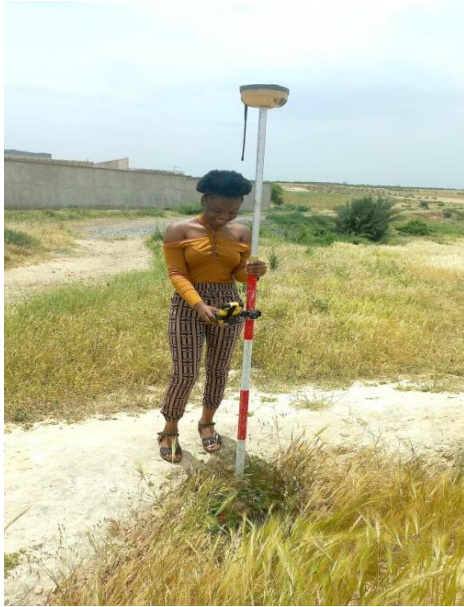
Figure 3: levés de coordonnées avec un GPS sur jalons
