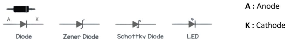
Figure 4:représentation schématique de la diode.
