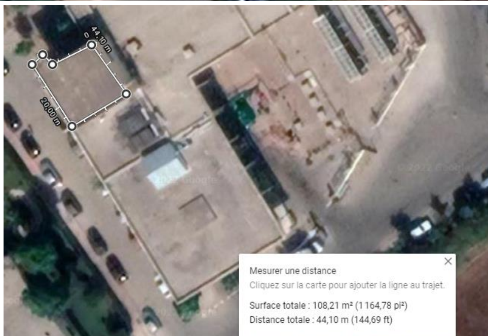
FIGURE 29 : SURFACES D'INSTALLATION PV DU POSTE4
