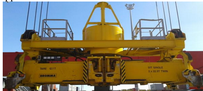
Figure 9: spreader STS 45 soulevé par les câbles en acier
