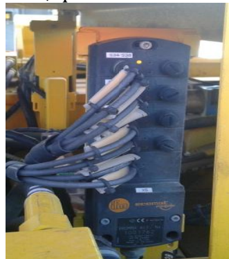
Figure 22: Nœud CANopen au niveau spreader
