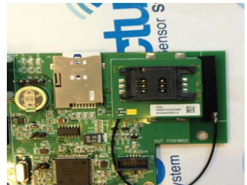
Figure 12 : module GPRS Telit GC864-
