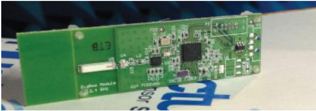
Figure 13 : module ZigBee 2,4 GHz 802.15.4
