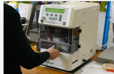
Figure 12 : Machine de Sertissage manuel
