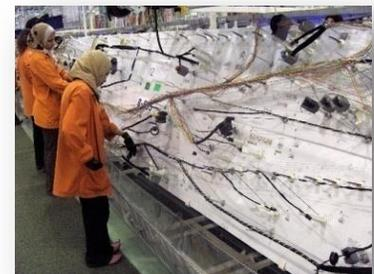
Figure 16 : Chaîne avec tableaux (Jig)
