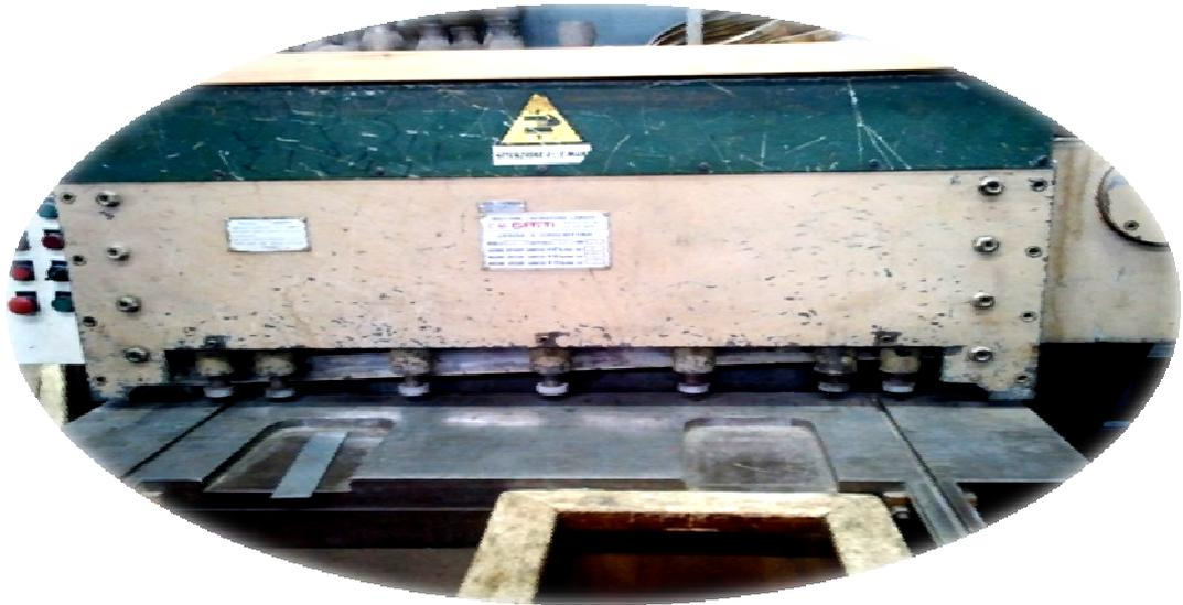
**Image 1 : Machine de découpage automatique.**
