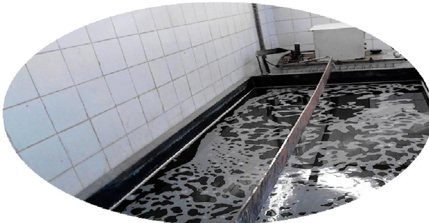
**Image 4 : Bain de dégraissage**
