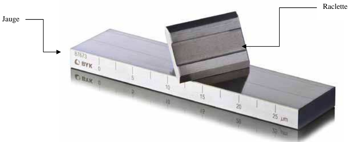
Image 2 : l'appareil de la jauge de finesse
