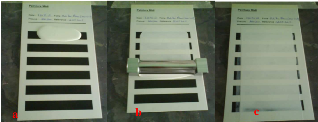
Image 8 : l'application de la peinture sur papier contraste
