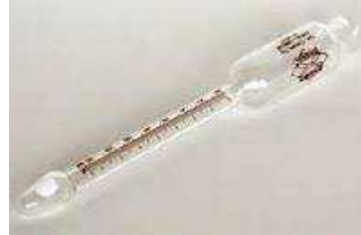
Figure 3 - 3 : Image d'un butyromètre
