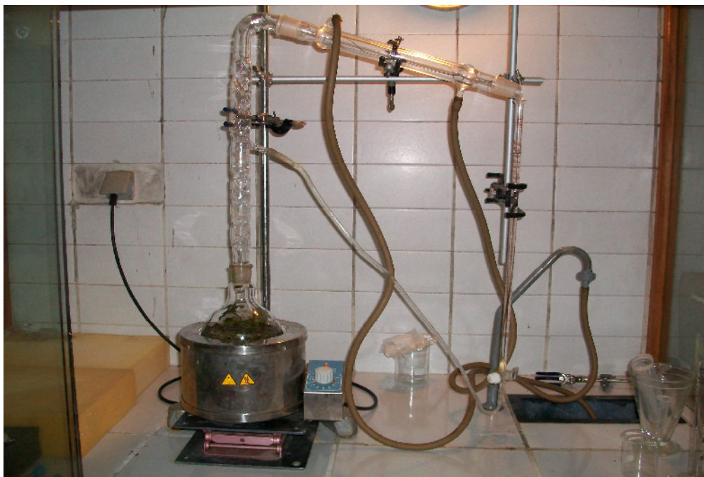
Fig.1: Système d'hydrodistillation (FSDM-FES)
