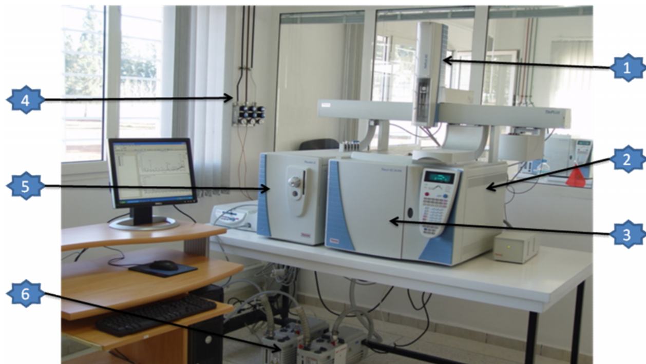
Fig. 2: Chromatographie en Phase Gazeuse Couplée à la Spectrométrie de Masse (GC/MS) (CURI- Fès)
