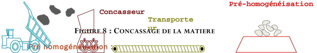
Après concassage, la matière crue présente toujours des fluctuations importantes dans sa composition, c'est pourquoi elle est introduite dans une tour d'échantillonnage puis stockée dans l'installation de pré homogénéisation. Voir (figure 9) :
