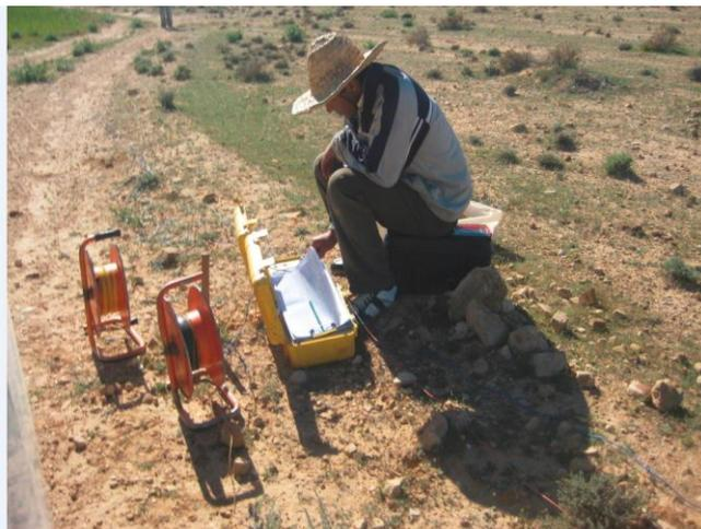
Photo 3 : étaler les files des bobines et prendre les mesures
