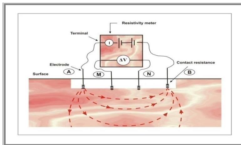
Figure 12: Principe de la méthode géoélectrique
