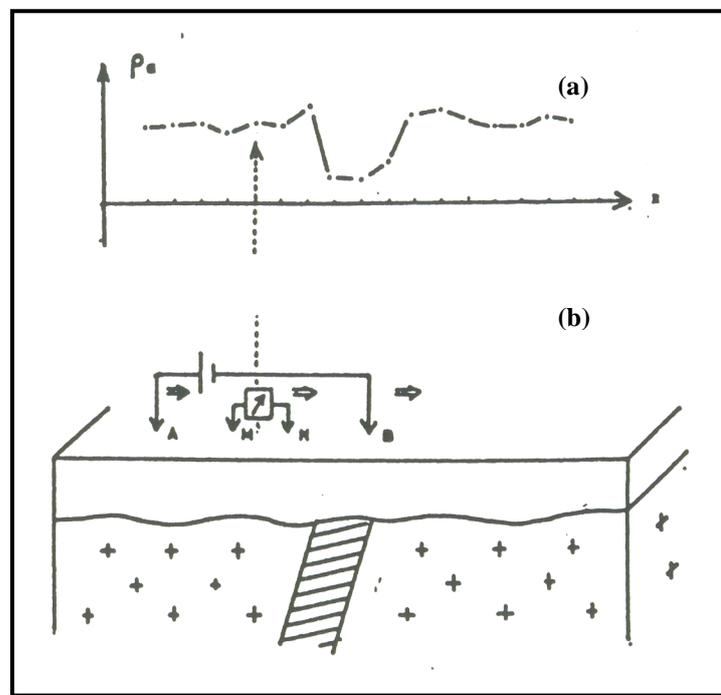
Figure 19: Mise en œuvre sur le terrain de la technique de traîné électrique
