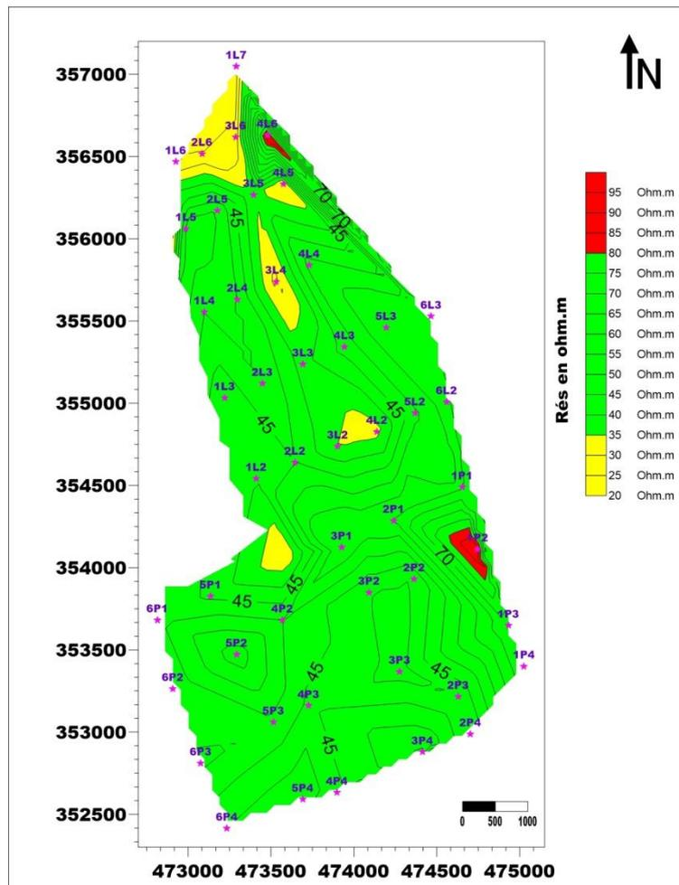
Figure 25: la variation de résistivité apparente pour une longueur de ligne AB= 300.
