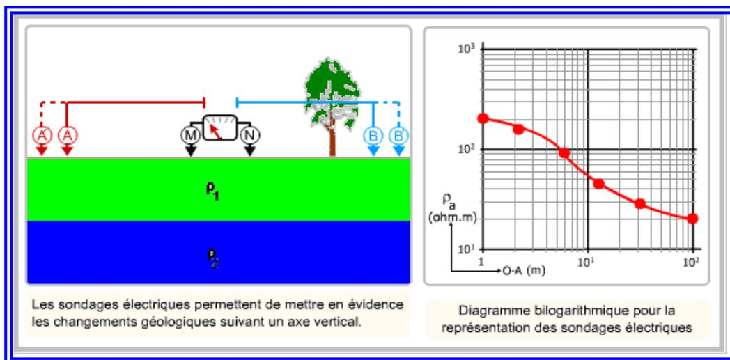
Figure 13: Technique de sondage électrique diagramme bi logarithmique
