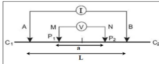
Dans le dispositif Schlumberger les électrodes de mesure (M et N) sont immobiles au centre du dispositif et on fait varier l'écart entre les électrodes d'injection; avec un écartement croissant la profondeur d'investigation augmente. On obtient ainsi des valeurs de résistivité apparente en fonction de la profondeur à la verticale du centre du dispositif.
