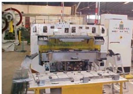
Figure 11. Machine de soudage
