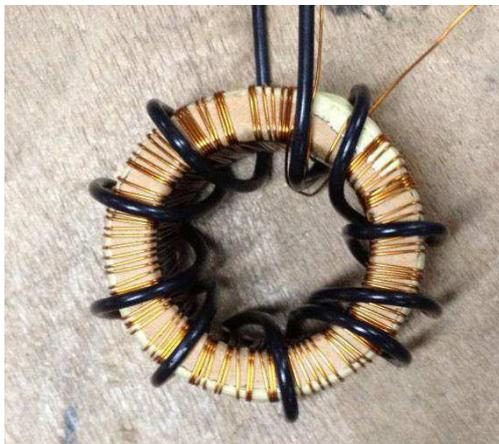
Figure 68: transformateur de tension
