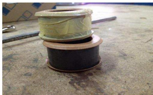
Figure 64 : Noyau de Fer avant et après isolement
