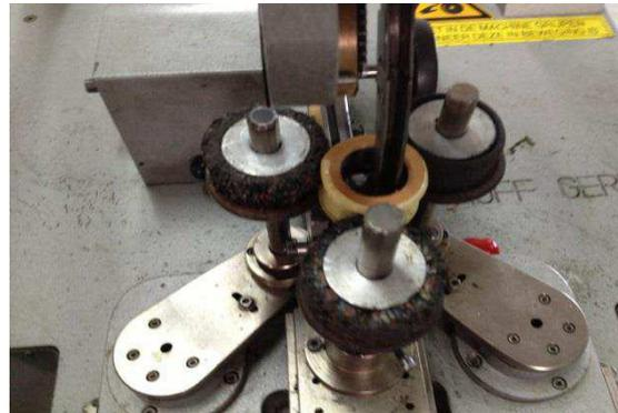
Figure 65 : Fixation du noyau entre les trois roues de rotation
