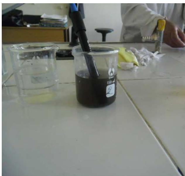
Photo II.4. Mesure des paramètres physicochimiques de l'eau potable et l'eau potable contaminée par 10% des lixiviats.
