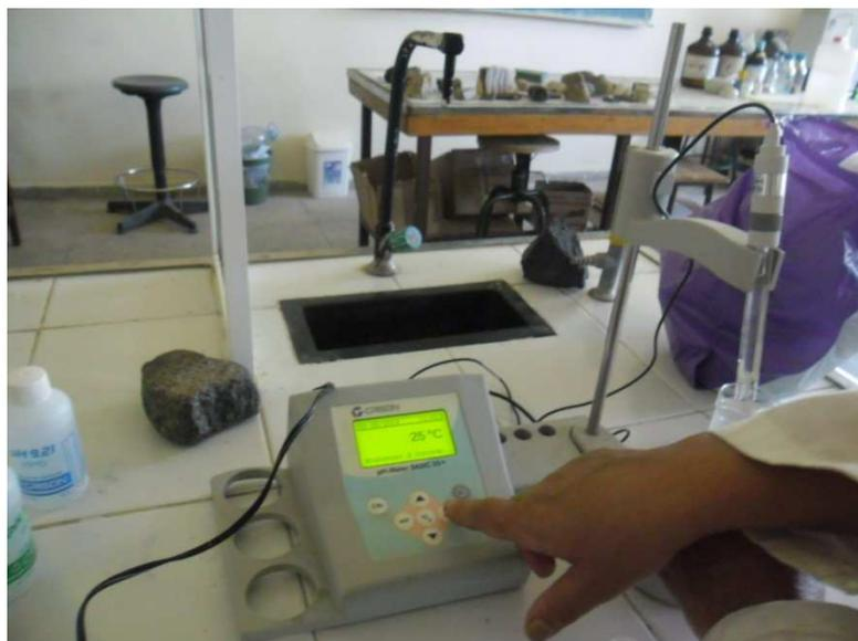
**Photo II.2. Le pH-mètre à batterie**
