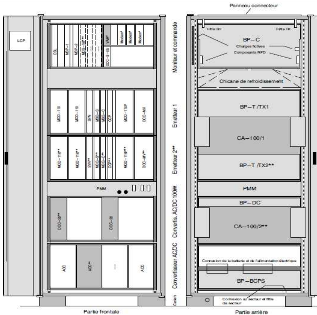
Figure 28: Emplacements de montage dans le bâti de l'émetteur VOR
