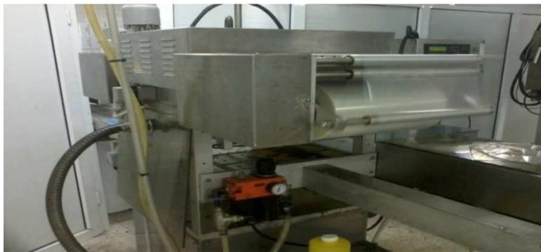
**Figure3**: Photo de l'operculeuse
