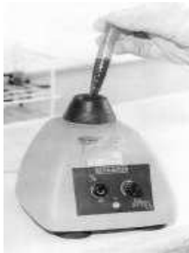
Fig. 15. L'homogénéisation de l'échantillon peut se faire à l'aide d'un agitateur vibrant, type Vortex.
