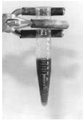
Fig. 18. Le culot, de 1 ml dans cet exemple, est remis en suspension dans 5 fois son volume de solution de zinc.
