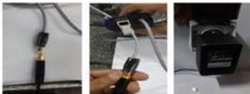
4- Relier le port « Target » de l'adapter(serial link kit) avec le port « MCI » de la presse à l'aide du câble MCI
