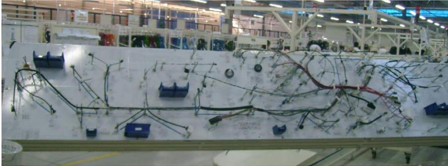
Figure 13 : planche de montage des faisceaux électriques
