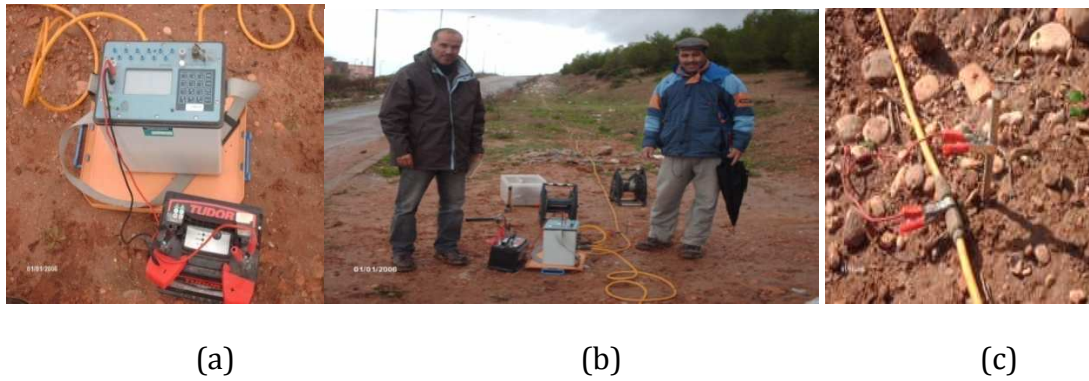
Photo 2-3-2 : Le dispositif multi électrodes (a), cables (b) et connexion (c)
