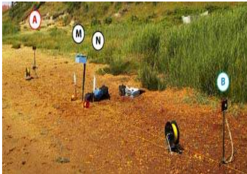
Figure 1.6.2 : La mise en œuvre des sondages électriques
